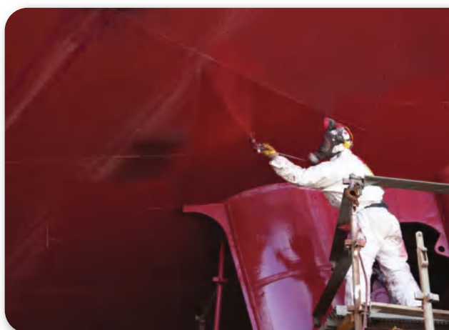
الشكل 4-16 لما كان التآكل يسبب الكثير من الضرر، فإنه من الأهمية بمكان إيجاد طرائق لمنع الصدأ. والطلاء أو أي غطاء حماية آخر هو أحد طرائق حماية هياكل المباني الفولاذية من التآكل.
