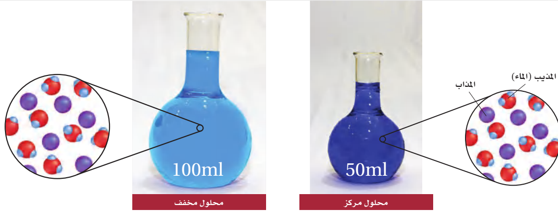
الشكل 6-1 يمكن تخفيف المحلول المركز بإضافة كمية من المذيب. لاحظ أن عدد مولات المذاب لا يتغير عند تخفيف المحلول المركز.
